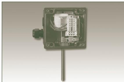
**TED环境...**温控器设计用于对电伴热电路进行环境感测控制。这个可调温控器可以用于控制单一的供热电路，或者对切换多个伴热电路的接触器进行引导控制。非金属外壳坚固耐用，具有防水和防尘保护功能（据IP66）。TED环境温控器批准用于普通（未分类）场所，并经过ATEX指令的认证，允许用于2类和3类（区1和2）场所。
