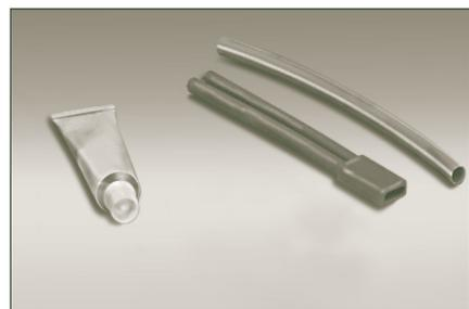
**KSR-CFK...**适用于危险和工业场所的电路预制套件。在JB-K-0-M25（或其他）接线盒内端接SX伴热带。套件包括电源靴、端盖、RTV粘合剂和黄/绿地线护套。
