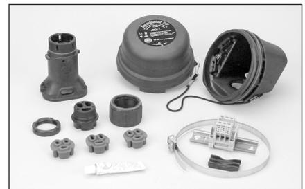
**Terminator ZP-M：**设计用于制作电源连接，在线两通连接或者用于尾部端接。要利用镀镍铜端子在接线端子中完成电气连接，以确保无腐蚀电气完整性。不需要冷端引线。最高暴露温度达250°C。
